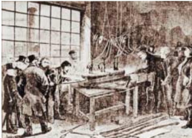
Metre standardı olarak kullanılan platin ve iridyum alaşımı çubuğun dökümü.
